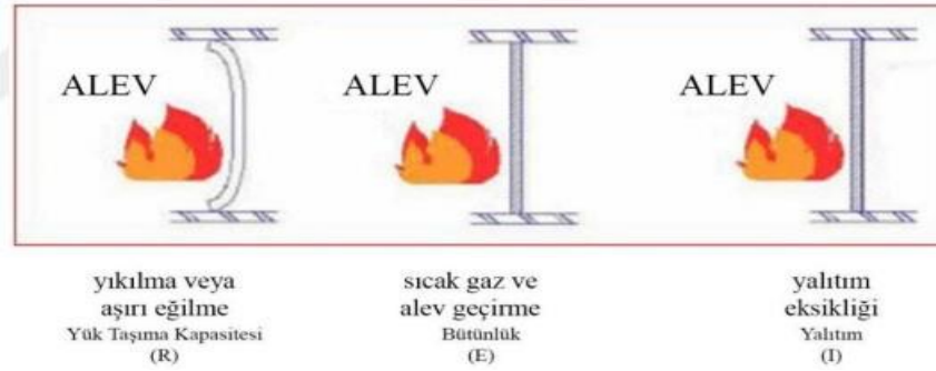
Şekil 16. Yapı Elemanlarının Yangına Dayanım Performansı
