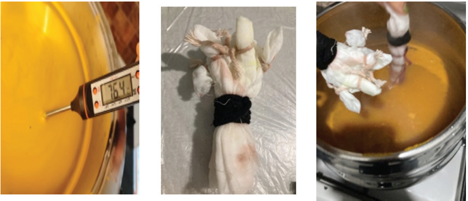
Görsel 2.1. Boyarmadenin dijital termometre ile ölçümü, pamuklu müslin kumaşın shibori tekniğinde bağlanması ve boyarmadde içerisine aktarılması.
