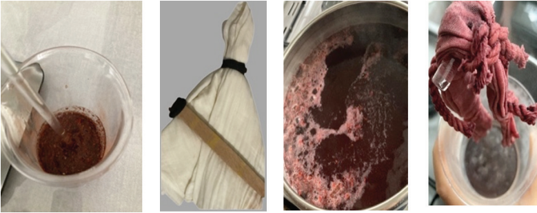
Görsel 5.1. Kök boya ( Rubia tinctorum L. ) maddesinin çözündürülmesi, kumaşın bağlanması ve çözeltiliye aktarılması
