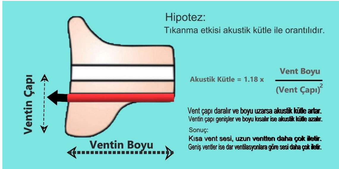
Şekil 23: Vent boyu ile çapının kütle üzerine etkisi ( Erişçi, 2018)
