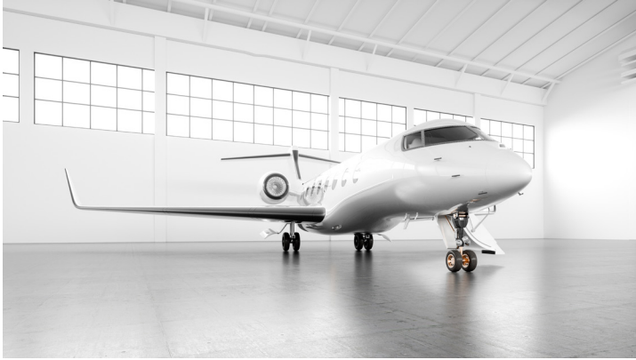
Resim 17: Tricycle Landing Gear (Shutterstock.com'dan alınan lisansla kullanılan görsel)
