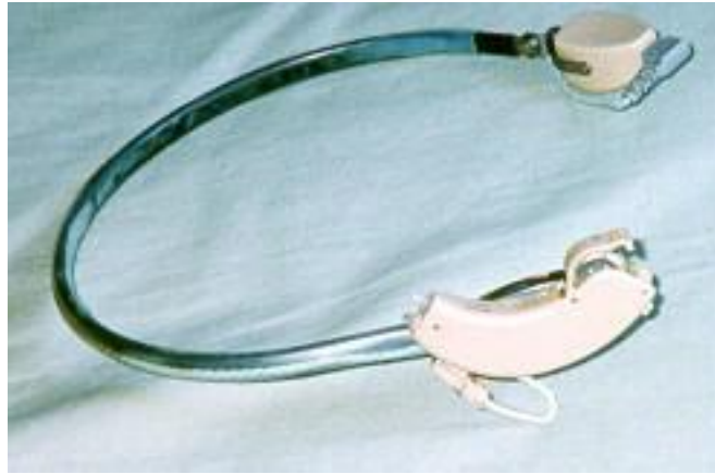
Şekil 11. Baş Bandıyla Kullanılan Cep Tipi İşitme Cihazı (Belgin ve Ataş, 2002)
